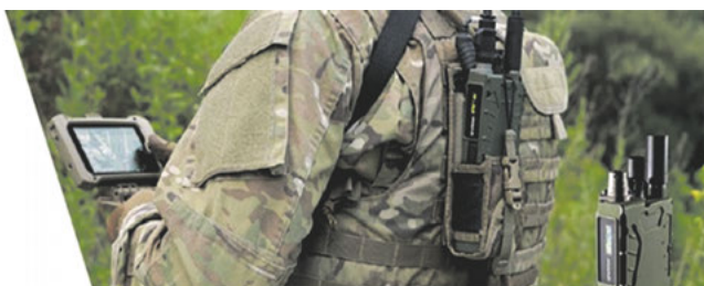
Сетевая многодиапазонная радиостанция AN/PRC-159(V)1 размещается на экипировке военнослужащего
