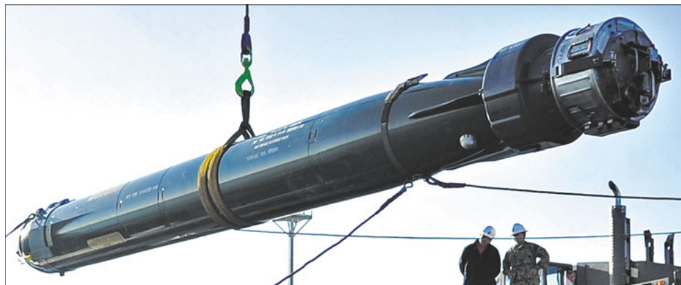
Загрузка универсальной торпеды Mk 48 мод. 7 в торпедный отсек многоцелевой атомной подводной лодки
