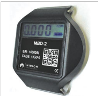
Индивидуальный дозиметр МВD-2 (такие приборы входят в комплект индивидуальной экипировки пехотинца)
