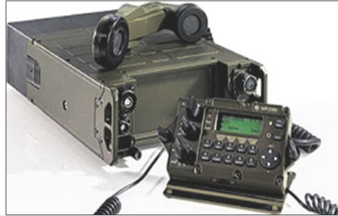
Комплект цифровой КВ/УКВ-радиостанции MR300 с высокой скоростью передачи данных
