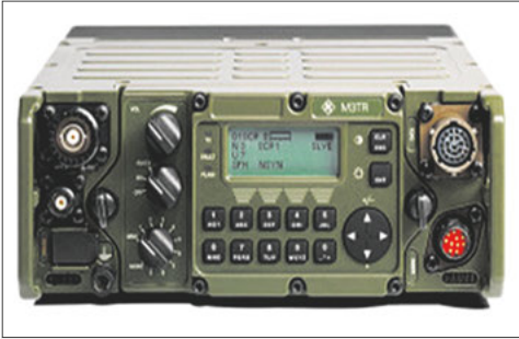
Комплект цифровой КВ/УКВ-радиостанции MR300 с высокой скоростью передачи данных
