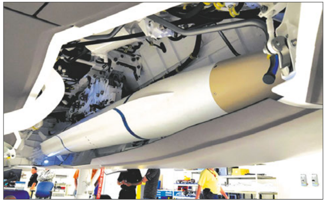
Противорадиолокационная управляемая ракета AGM-88G AARGM-ER в оружейной шахте тактического истребителя F-35
